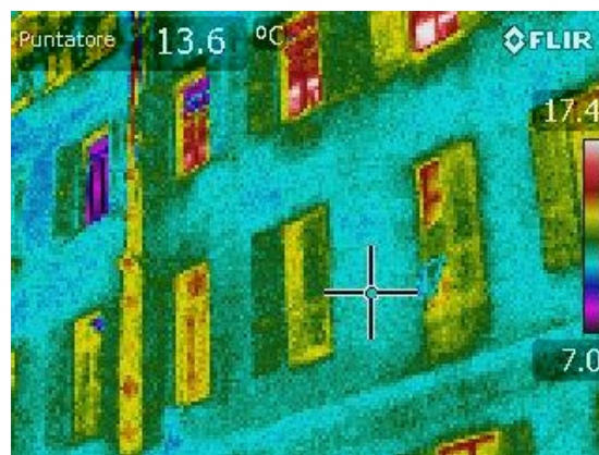
Figura 4.13 – Rilievo termografico dei serramenti esterni in pvc e vetrocamera
